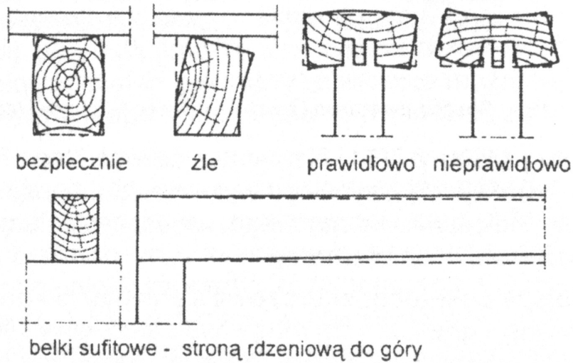
Rys. 1.12 Deformacje krawędziaków drewnianych na skutek skurczu
